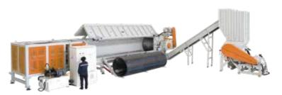
DYSSG系列撕碎机组可用于直径1200MM的PE、PP、PVC管材撕碎,长度达3-6M的管材直接破碎,无需分割,其转速缓慢运转平稳,各种管材放入水平的喂料槽中,喂料槽自动关闭由液压推进将管材推向轴中心进行破碎。撕碎后的材料通过输送机带入破碎机进行二次破碎完成需要的破碎颗粒直径。
